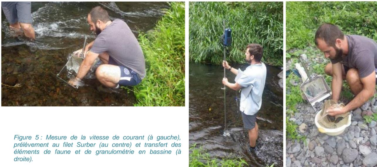
Figure 5 : Mesure de la vitesse de courant (à gauche), prélèvement au filet Surber (au centre) et transfert des éléments de faune et de granulométrie en bassine (à droite).
