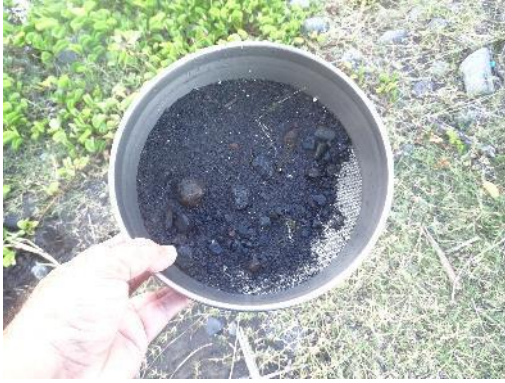
Figure 3 : Prélèvement pré-trié à l'aide d'un tamis de maille 0.5 mm (© BIOTOPE)
