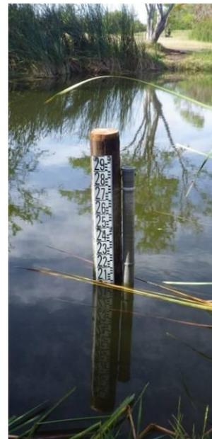
Figure 6 - Kiosque et échelle de l'Office de l'Eau à l'embouchure de l'étang (Gauche et centre ; OCEA 04-02/01/13) ; Echelle et sonde pression équipées et suivies par OCEA sur la gravière "Mer" (Droite ; OCEA 28/01/13)
