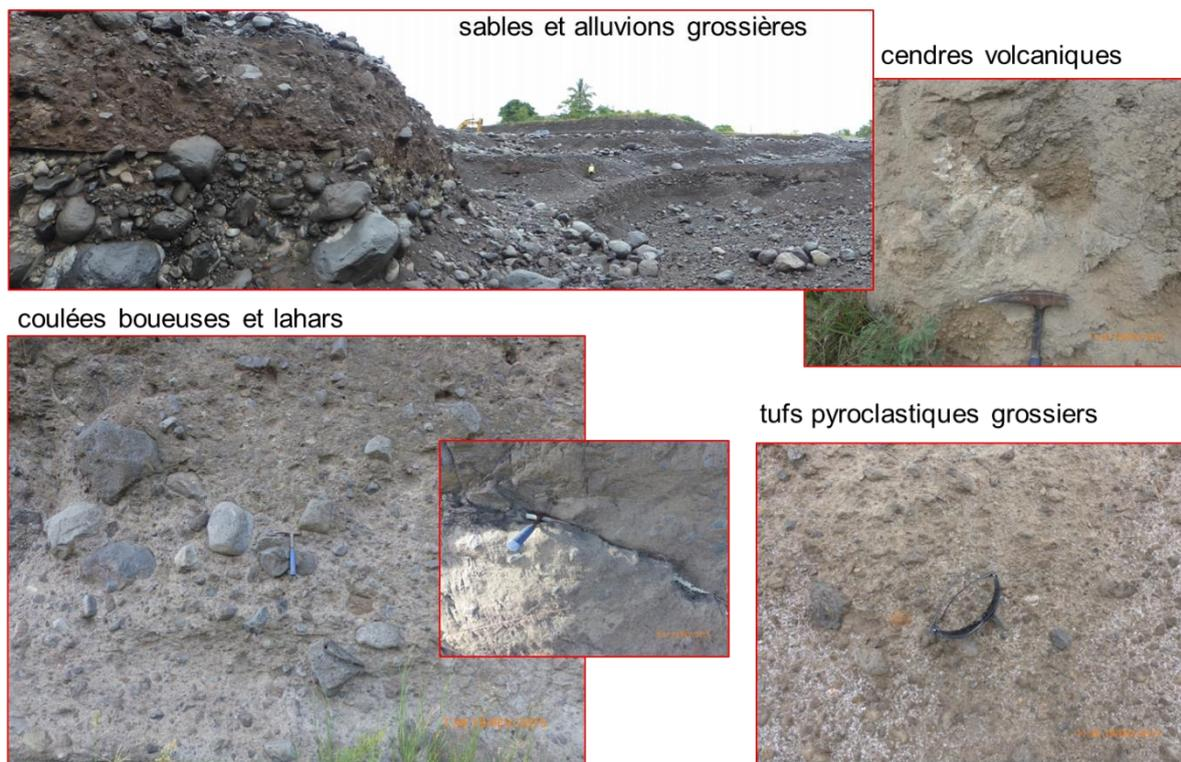
**Figure 2.6: Formations superficielles observées sur le secteur de Pierrefonds.**
