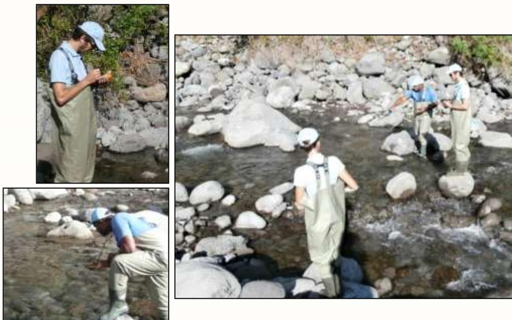
Figure 2 : En bas à gauche: mesure des faciès avec un télémètre; En haut à gauche: enregistrement des données et calcul des surfaces; A droite: repérage et concertation
