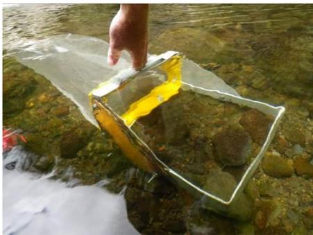
Figure 1 : Filet Surber à surface adaptée (© BIOTOPE)
